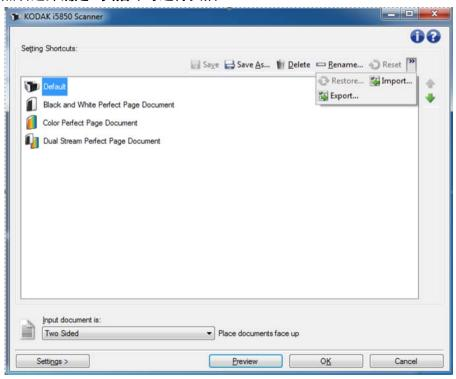
**设置快捷方式** — 提供当前所设置的"设置快捷方式"列表。提供的快捷方式包括:
