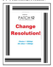
注意: 扫描应用程序(例如 *Kodak* Capture Pro 软件)亦可在**停止扫描**补充码页上内嵌数据以自动变更扫描仪设定并重新启动扫描,将所有需要的变更完全自动化。
