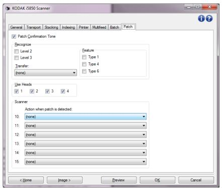
**分隔确认声音** — 确认声音可用来指示补充码是否已被扫描仪识别。默认为无确认色调。
