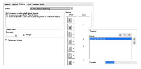
3. **完整影像位址处理**。 i5850 和 i5850S 扫描仪提供影像位址处理选项, 所提供的选项完整且计数多达三个层级。包含影像寻址功能且可用于 i1860 和 i800 扫描仪的应用程序亦适用于 *Kodak* i5850/i5850S 扫描仪。
