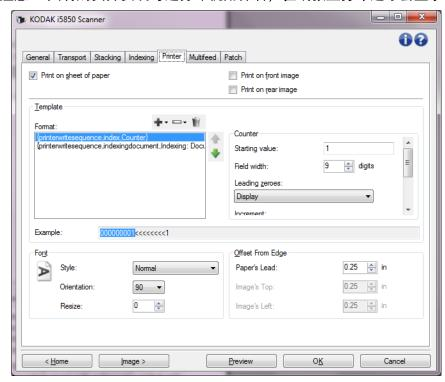
在正面影像上打印 — 对于所有正面影像,打开数字打印。
