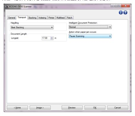
**处理** — 允许您选择扫描仪运输纸张通过扫描仪的方式。这会影响文档送进扫描仪的方式、文档通过扫描仪的速度,以及在输出托盘中放置文档的方式。
