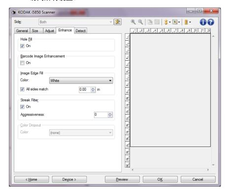
**填充洞孔** — 允许您填充影像边缘周围的洞孔。填充的洞孔类型包括:圆形、矩形和不规则形状 (例如,双穿孔,或从文件夹中取出文档时可能会发生的轻微损)。选中**开启**可开启"填充孔"。
