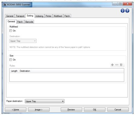
纸张目的文件 — 表示所有未分类纸张被发送到的默认输出位置通常,已分类纸张的纸张目的文件不同于此位置。这三个"分类"子选项卡中都会出现此选择。对其中任何一个更改将同时更改另外两个。
